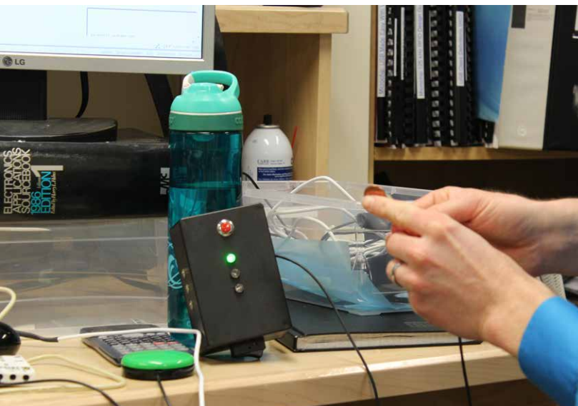
Le capteur tactile aide les patients à motricité fine limitée à utiliser le cliqueur Cassidy et les autres commutateurs de réadaptation.
